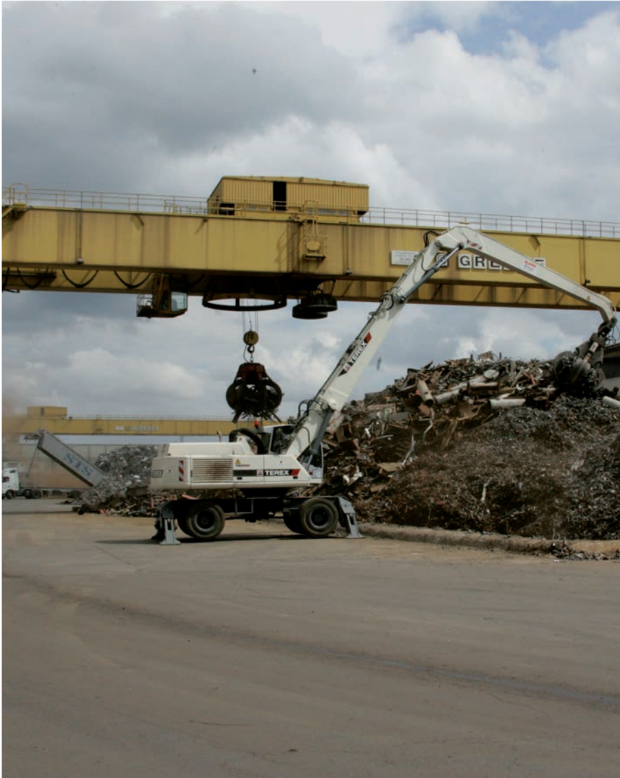
Stockage de ferraille, la matière première pour alimenter le four électrique
